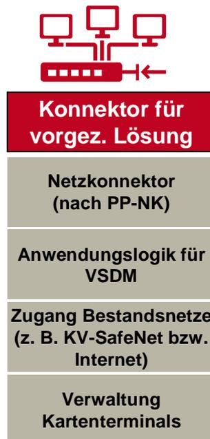
Abbildung 12: Funktionale Bestandteile des Konnektors der vorgezogenen Lösung
